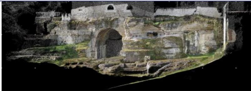
Dans le cadre d'un projet de fin d'étude, trois apprentis du BTS MGTMN doivent réaliser un modèle 3D. La technique de photogrammétrie a été utilisée par drone et appareil photo pour la mise en valeur d'un site historique. Le modèle ainsi obtenu servira à concevoir plusieurs documents techniques et de communication (plan topographique, coupes, vidéo et visite virtuelle).
