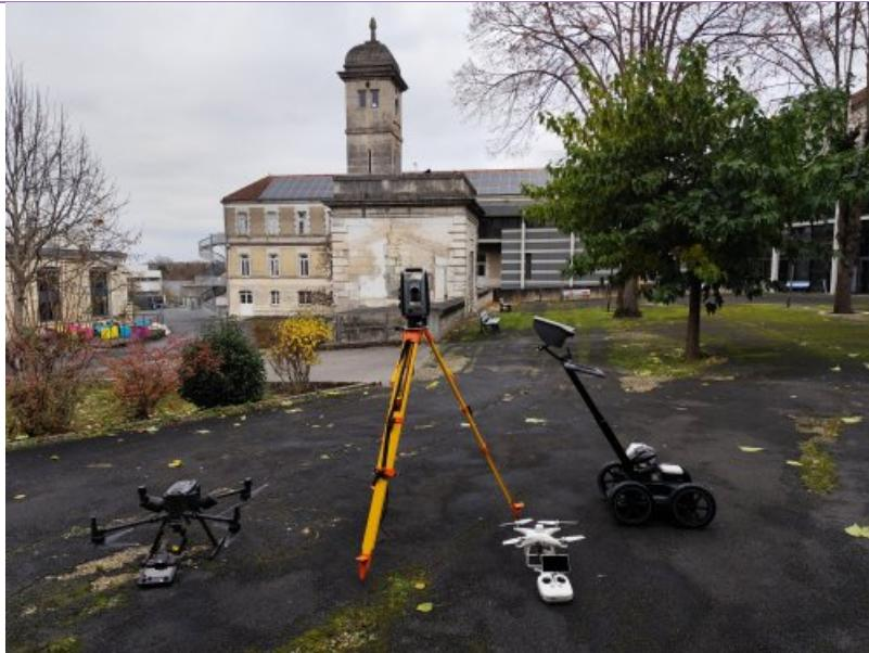
Nous remercions la société GEOMESURE pour le dons de matériel suivant ; géoradar, drônes et station totale. Cela permettra à l'ensemble de nos formations (BTS et BAC-PRO Géomètre-Topographe) d'être encore plus performantes dans l'acquisition des données de terrain en cette nouvelle année 2025 qui commence.
