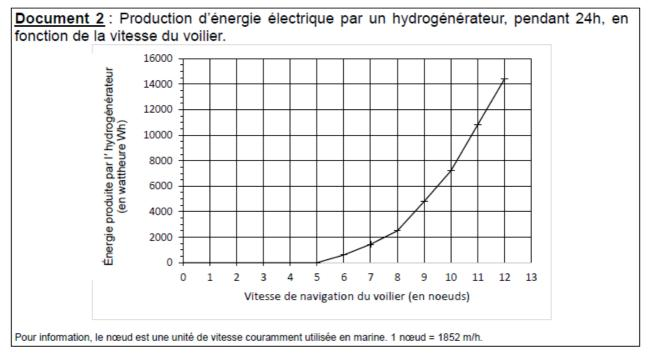
A l'aide du **document 2**, indiquer à partir de quelle vitesse de navigation du voilier, en nœuds, l'hydrogénérateur produit de l'énergie électrique.
