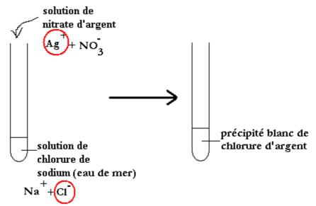
Quand on verse quelques gouttes d'une solution de nitrate d'argent sur l'eau de mer (solution de chlorure de sodium), les ions chlorure Cl<sup>-</sup> présents dans l'eau de mer, réagissent avec les ions argent et il se forme un précipité blanc de chlorure d'argent qui noircit à la lumière.
