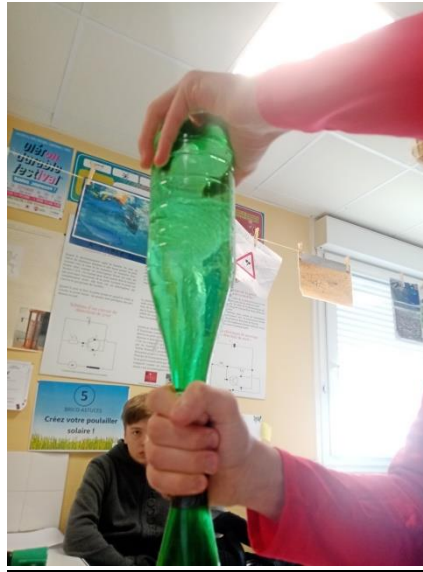
Photo2 : Bouteilles reliées par un bouchon percé avec un trou de 6 mm
