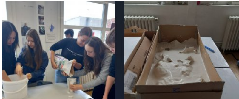
Plâtre de Paris et coffrage pour fabriquer le moule.
