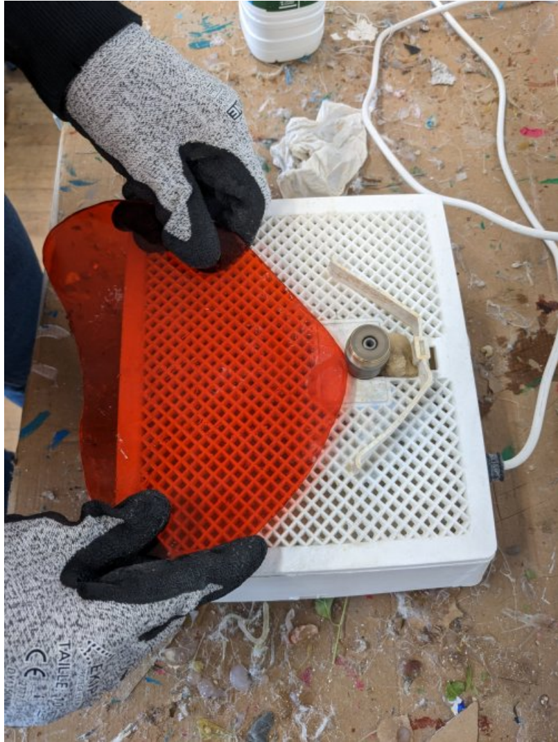
Polissage du verre avec une machine dédiée.
