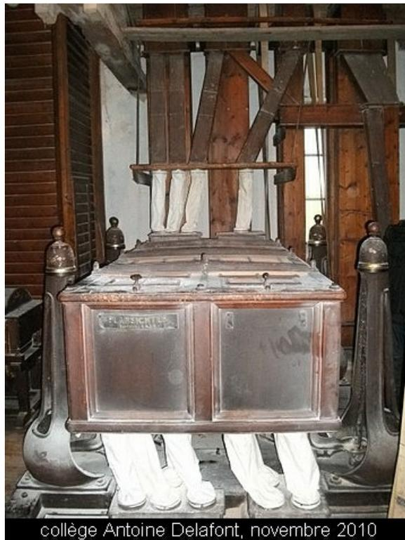
**On attache les sacs de farine à un entonnoir et on ouvre une trappe, puis la farine tombe dans le sac. On utilise un diable pour transporter les sacs de farine .**
