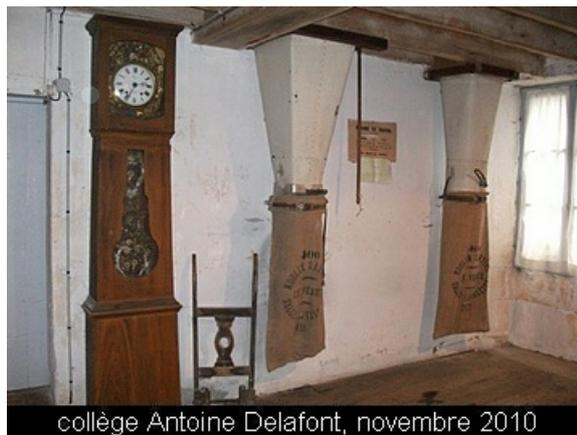
**Ce sont des sac de farine qu'on faisait passer par des trappes dans les étages. On tire la ficelle, puis le sac monte . Avant on les faisait passer par la fenêtre maintenant on ne le fait plus .**
