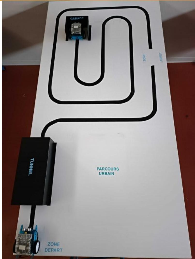
Le robot doit effectuer l'ensemble du parcours matérialisé par une ligne noire, il devra allumer ces lumières bleues sous l'ensemble du tunnel et marquer un arrêt de 2 secondes en émettant un son dans la zone prévue. Il devra ensuite s'arrêter dans le garage sans toucher le mur et après un bref arrêt, reculer, faire un demi tour et parcourir le chemin inverse.
