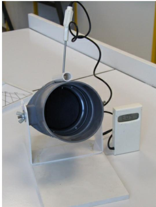
La partie principale est un disque métallique peint en noir mat et placé au fond du tube. La chaleur absorbée est mesurée par un thermomètre introduit dans un trou latéral au centre de ce disque. Le tube est orientable et se place face au soleil en utilisant la projection de celui-ci au travers du petit tube de visée (ne jamais regarder directement le soleil)
