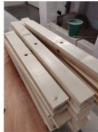
Perçage des branches pour le passage de la tige filetée
