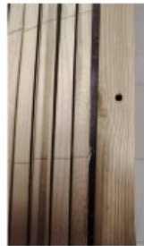
Perçage des branches pour le passage de la tige filetée
