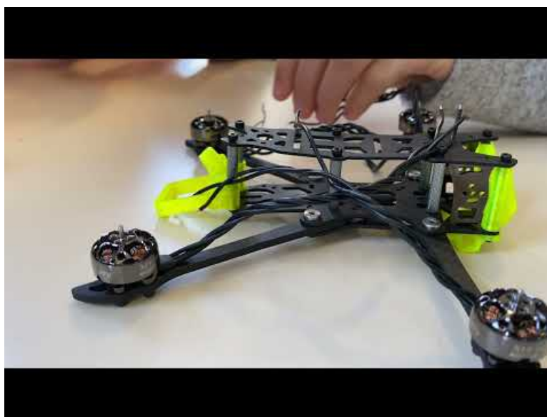
Installation des moteurs et début de soudure du contrôleur. (Video Youtube)
