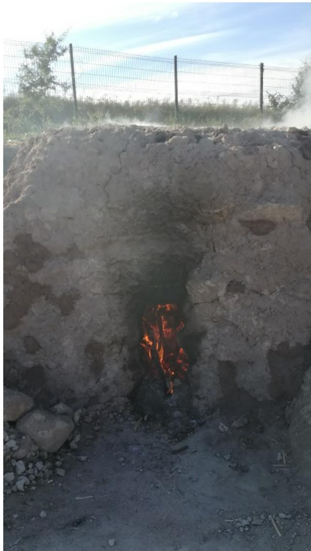
La cuisson de la chaux a demandé une alimentation constante (toutes les 7 min env) et une surveillance permanente. Pour le retour sur expérience, nous avons pris soin de mesurer la température quasiment toutes les 20 min au thermomètre laser, mais aussi de prendre des clichés à la caméra thermique.
