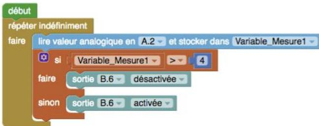
Exemple avec le capteur de température qui communique sur l'entrée A2 du microcontrôleur.
