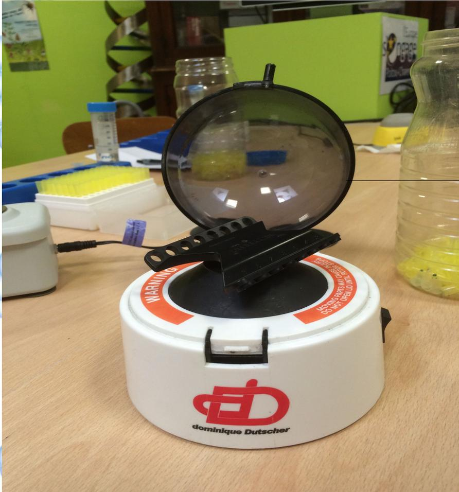
Une centrifugeuse pour que la solution tampon soit au fond du tube.
