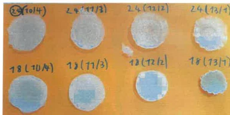
Après différentes séries de tests, nous avons déterminé la meilleure composition du plastique à base d'agar : les plastiques ayant la meilleure texture (souple, peu de rétraction, solidité)
