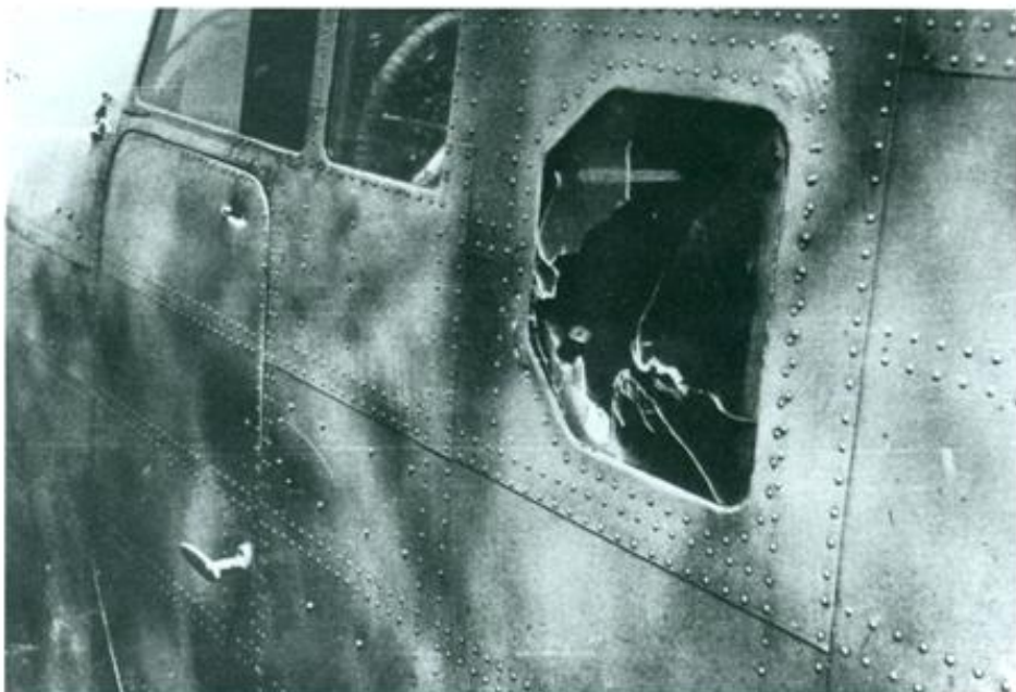
Détail d'un impact de 20 mm sur le fuselage du MM 21504. (coll. G. Garellò)
