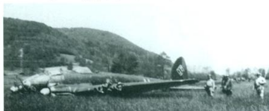
Trois jours plus tard, c'est le He 111 WNR 2648 « 9K+DD » du Stab III./KG 51 qui est victime du futur « as » à Fougerolles. L'appareil, dont le bord d'attaque du plan gauche a été défoncé par un arbre, dispose d'un équipement photographique monté à la place de la rangée droite du lance-bombes. Il sera démonté le 17 mai pour être transporté sur la base d'Orléans-Bricy (coll. Robert via Histavia21).
