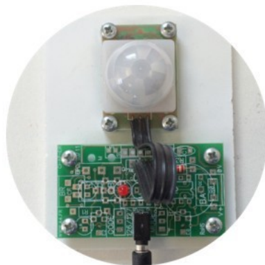
Capteur infrarouge : détection des personnes
