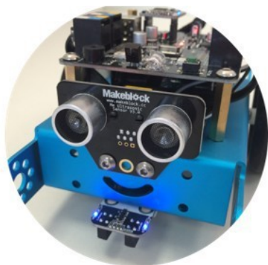
Capteur Ultrason : détection d'obstacle
