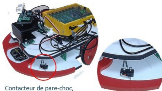
Contacteur de pare-choc, détecte si le pare-choc est enfoncé ou relâché
