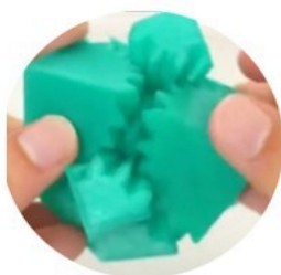
Par addition de matière avec une imprimante 3D.
