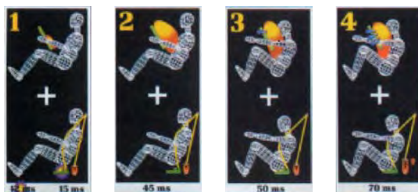
Document 3 (source : RENAULT): Fonctionnement du système de retenue (SRP)
